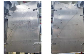
T-DIE 온도 센서 설치 모습
